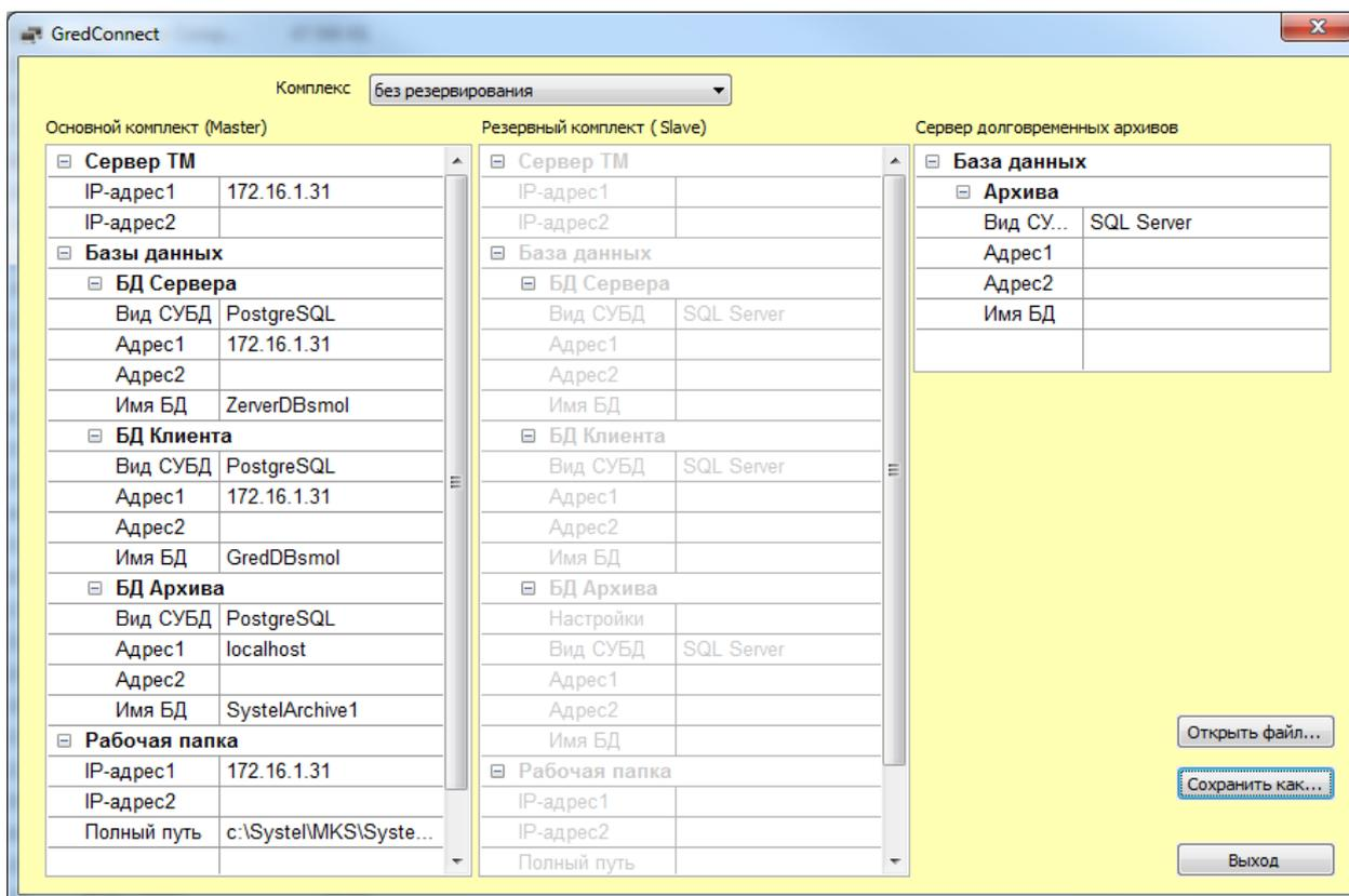
Рисунок 7 - модуль описания доступа к серверным компонентам.
