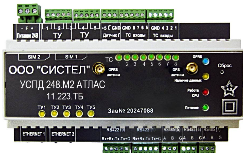
Рисунок 7 – Внешний вид УСПД с дополнительным модулем вывода дискретных сигналов ТУ5 (модификация 11.223.ТБ)
