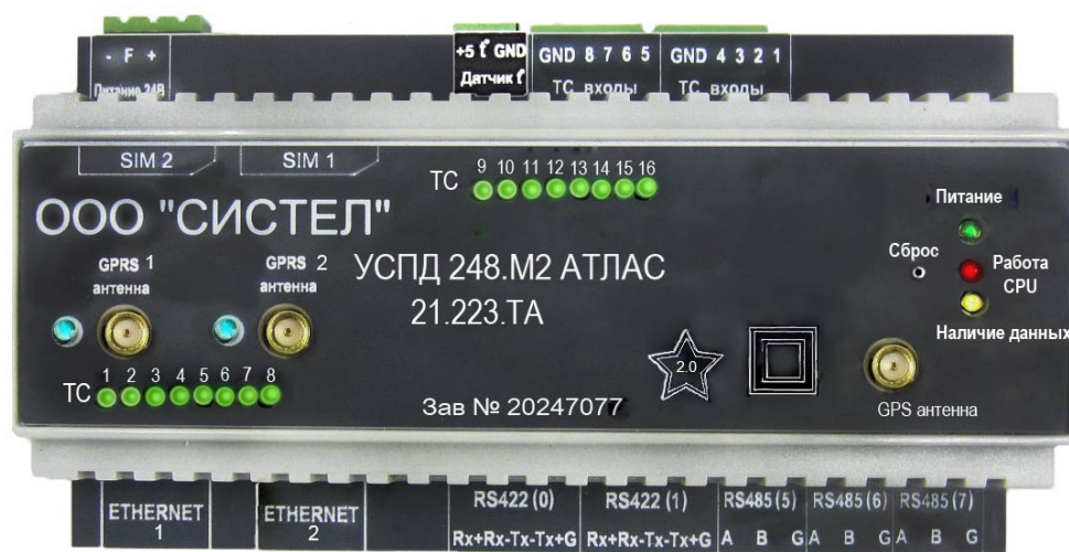
Рисунок 7 – Внешний вид УСПД с дополнительным модулем вывода дискретных сигналов ТУ5 (модификация 11.223.ТБ)
